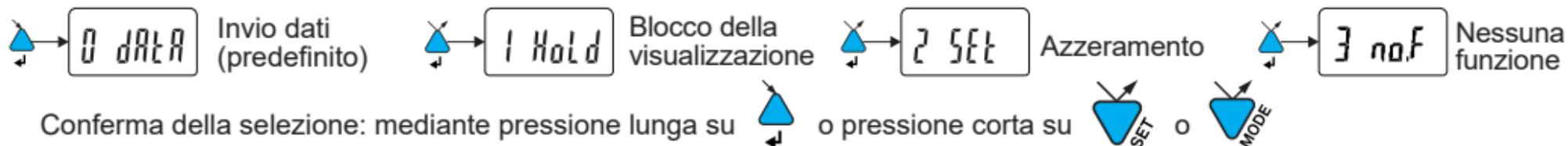
**Nota:** la funzione può essere assegnata anche mediante RS232, con il comando <FCT + N° di funzione> (FCT 0...3); esempio: Blocco della visualizzazione = <FCT1>
